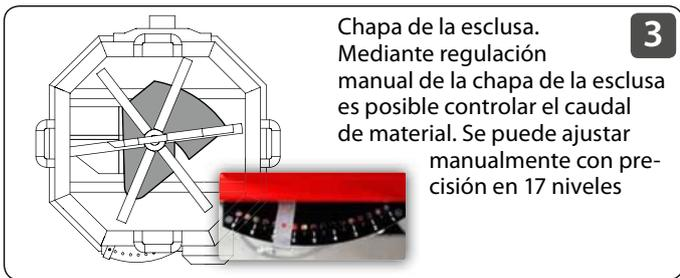
Chapa de la esclusa. Mediante regulación manual de la chapa de la esclusa es posible controlar el caudal de material. Se puede ajustar manualmente con precisión en 17 niveles
